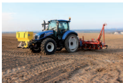
Instalacja z przodu ciągnika i agregatowanie z siewnikiem do siewu buraka cukrowego.
