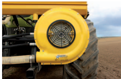
Wentylator jest połączony z układem hydraulicznym ciągnika.
